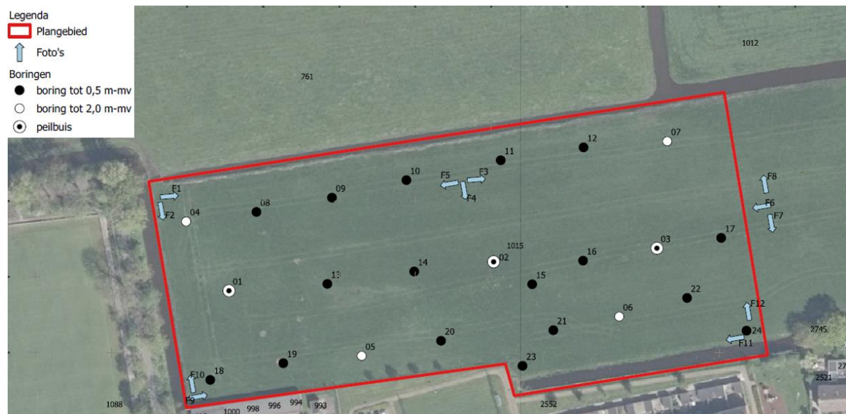
Afbeelding 9: uitgevoerde boringen ten behoeve van het verkennend bodemonderzoek
